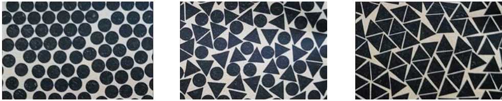
Abb. 5.20. Modellversuche mit beweglichen flachen Objekten zur Simulation eines Mischvorganges. (Aus Wolf 1954, 408).
