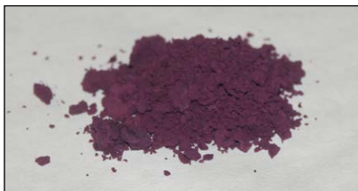
Abb. 23: Florentiner Lack, vom Autor hergestellt mit Zusatz von Eisen(II)-sulfat
